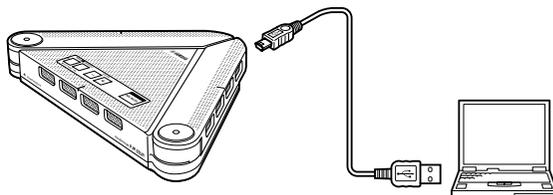
使用随机附带的 USB 线将本设备连接至计算机。
